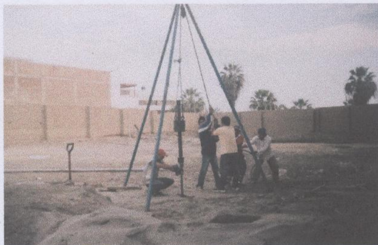
PRUEBA DE CONO PECK (PARA CONOCER LAS PROPIEDADES MECANICAS DEL TERRENO) EN EL TERRENO UBICADO EN PIMENTEL – CHICLAYO – LAMBAYEQUE , DONDE SE PROYECTA LA CONSTRUCCION DEL EDIFICIO SPONDYLUS, EDIFICACION DE 11 NIVELES + 01 SOTANO
